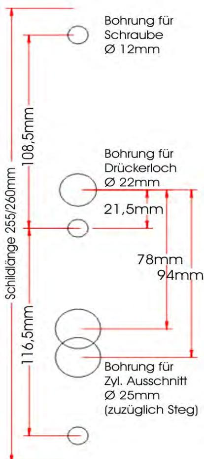
**Sicherheitsrosetten Edelstahl matt gebürstet,** sind für Systembeschläge Maco, Siegenia, Roto usw. mit einer Schraubenlochdistanz von 63mm zur durchgehenden Verschraubung bei Fensterverschlüssen mit Zylinder.
