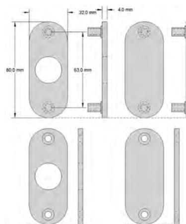
**Blindrosetten aussen, Edelstahl matt gebürstet,** sind für Systembeschläge Maco, Siegenia, Roto usw. mit einer Schraubenlochdistanz von 43mm zur durchgehenden Verschraubung mit dem Fenstergriff.
